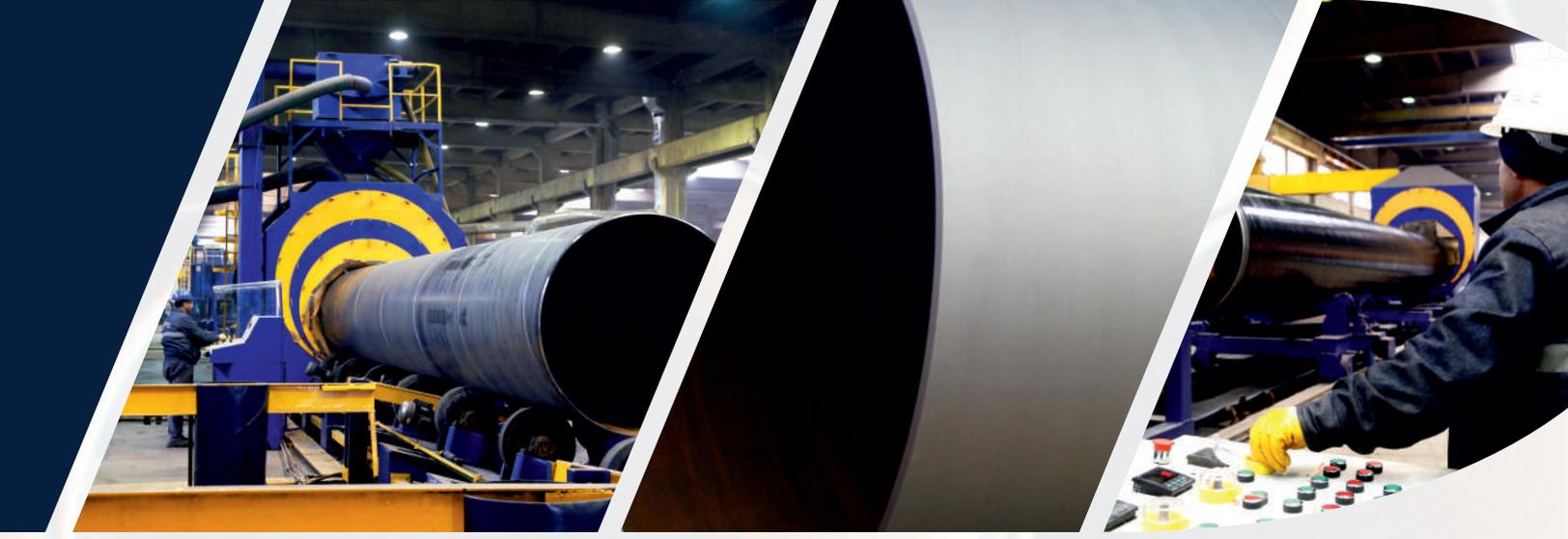
Çıplak olarak tahribatlı ve tahribatsız tüm kontrollerden geçen borular, kaplama öncesinde yüzeylerindeki pas, toz, tufal, yağ gibi dış etkenlerden temizlenir. Bu amaçla boru iç ve dış yüzeyleri kumlama hattına alınır ve çelik granül ile DIN 55928 veya ISO 8501/01 standardına uygun olarak Sa 2 1/2- Sa3 kalitesinde otomatik makinelerde kumlanır. 50-90 mikron arası yüzey pürüzlülüğü elde edilir.
