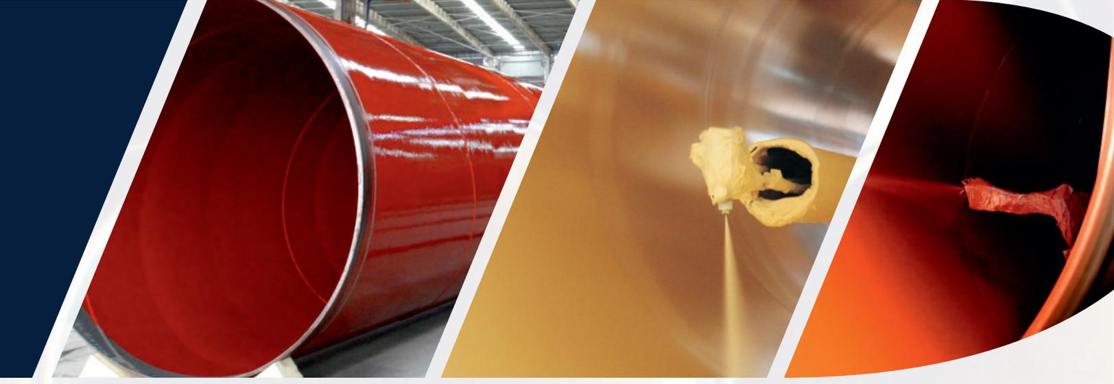
Kumlanan boru otomatik arabalarda istenilen sürat ayarlanarak kendi etrafında döndürülür bu aşamada borunun dönme eksenine dik hareket eden bir arabanın ileri-geri hareketi vasıtasıyla borunun içine veya dışına pompalar ile boya püskürtülür.
